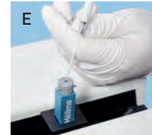
Neue Probe auf das Messfenster pipettieren.
